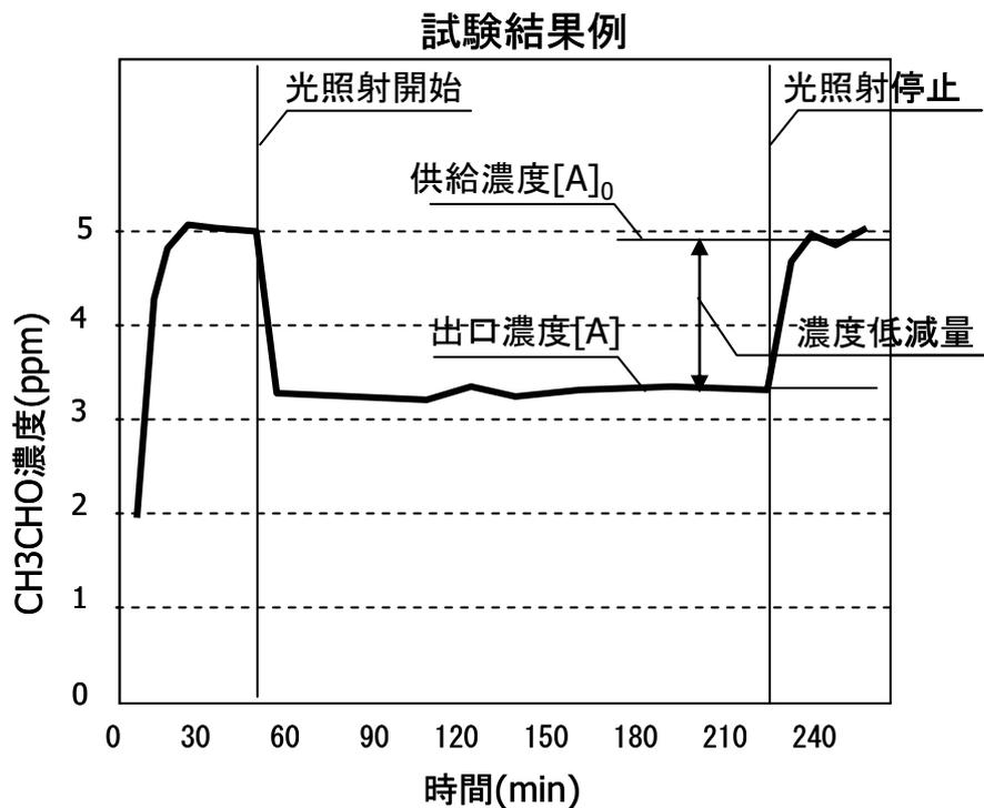
図2 JIS R 1701-2 試験結果例
