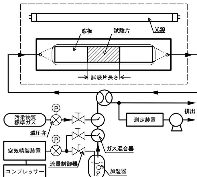
図1 JIS R 1701 試験装置図
